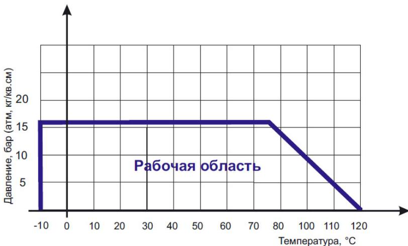
Эксплуатация задвижек предусматривается при температуре окружающей среды:
